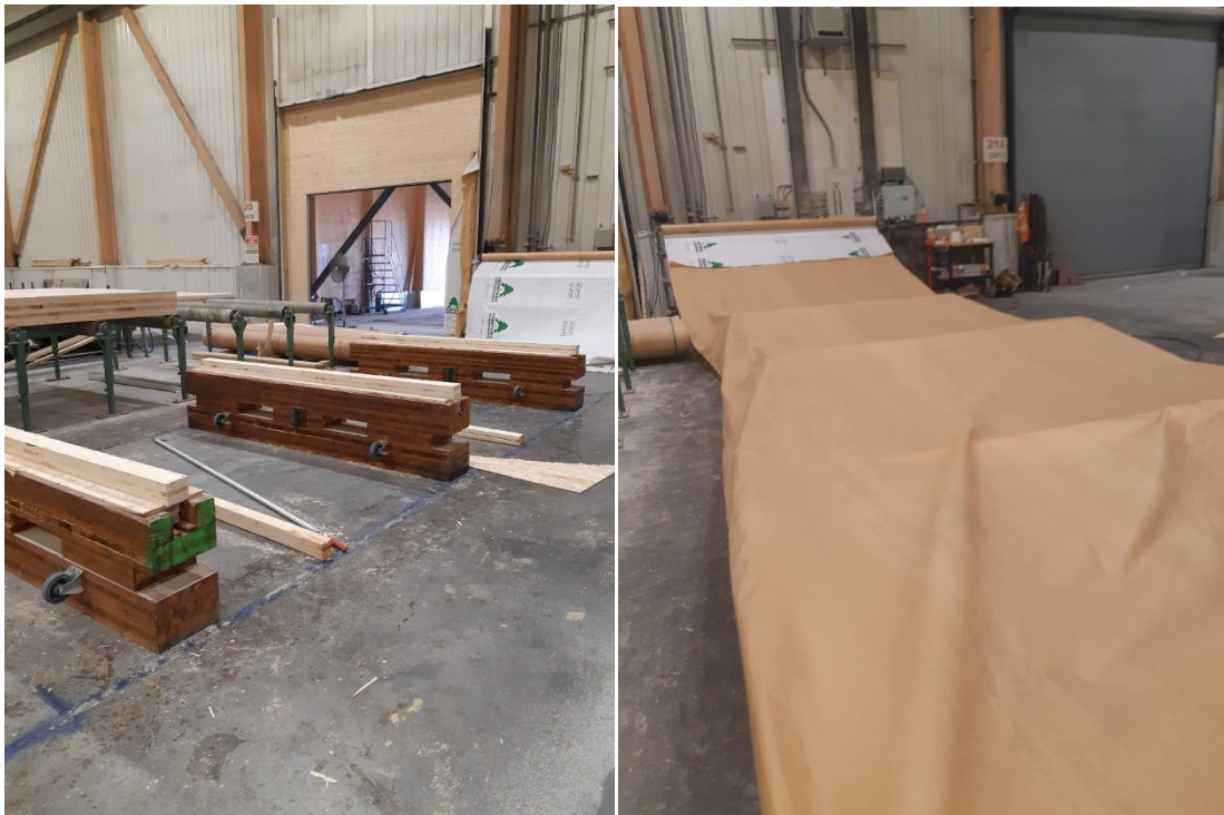
Figure 4.2 Tout d'abord, l'emballage est déroulé sur un bloc de bois qui a été placé sur des appuis en bois.
