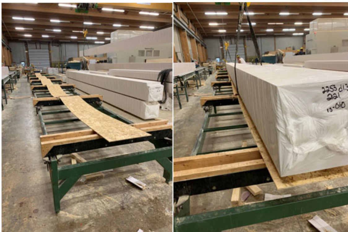
Figure 4.13 Des feuilles d'OSB sont ensuite placées sur des appuis en bois équidistants et les éléments en bois lamellé-collé enveloppés y sont déposés par-dessus. Pour plus de stabilité et de sécurité lors de la manipulation, les éléments en bois lamellé-collé sont empilés à plat.
