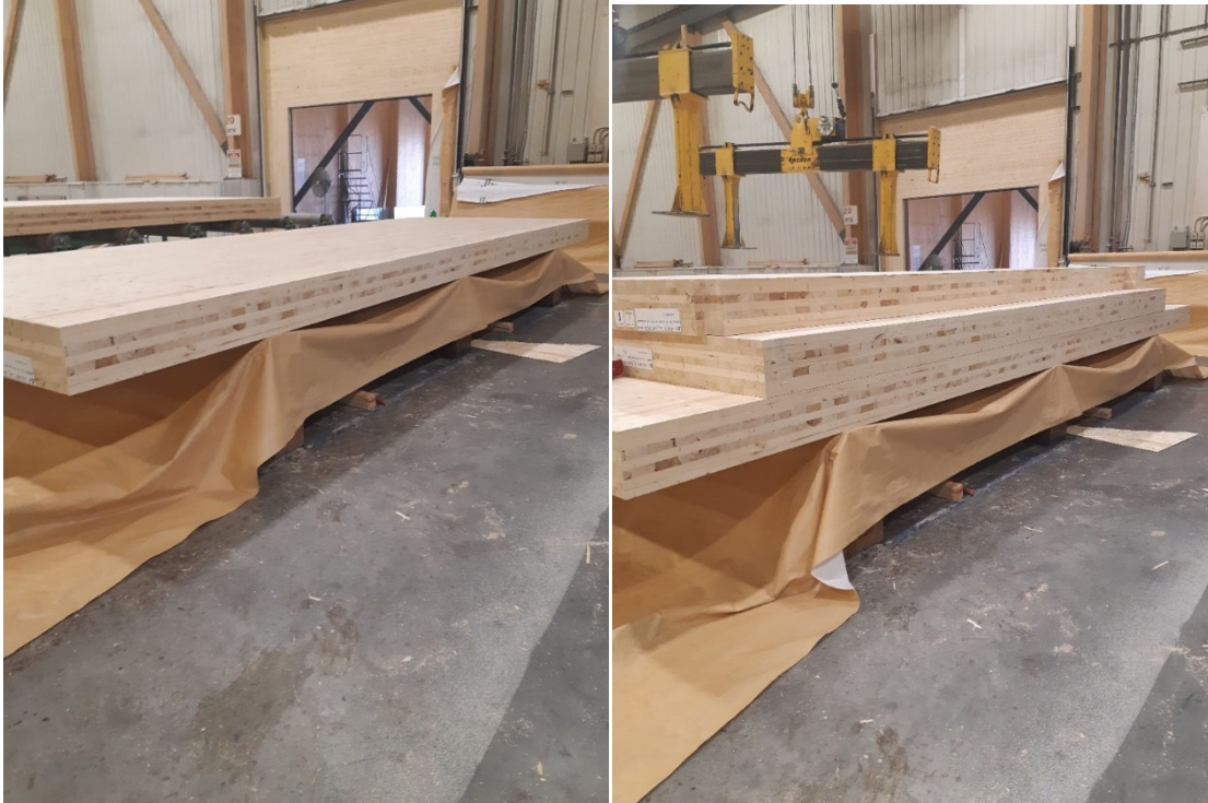
Figure 4.3 Les panneaux en bois lamellé-croisé sont ensuite empilés sur l'emballage, face architecturale vers le bas. Des panneaux à copeaux orientés (OSB) sont insérés entre l'emballage et la face inférieure du panneau inférieur pour protéger les OSB contre les dommages en cas d'entreposage à long terme.
