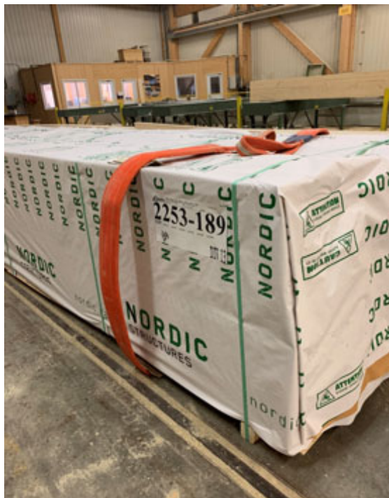
Figure 4.14 L'ensemble du paquet, y compris le bloc de bois qui maintient le bois lamellé-collé en hauteur, est ensuite attaché. Les paquets sont étiquetés, soulevés et empilés pour l'entreposage.
