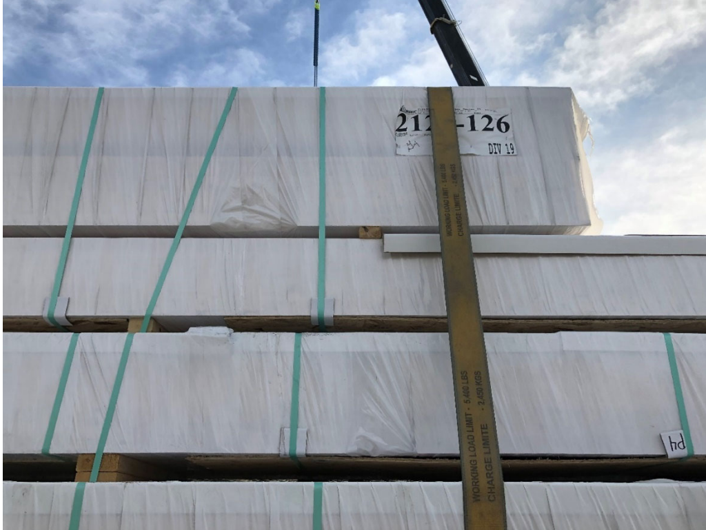
Figure 4.15 À l'usine, un pont roulant ou un chariot élévateur à fourche est utilisé pour charger les paquets sur les camions; des chariots élévateurs à fourche sont utilisés pour charger les paquets sur les trains. Tous les colis sont attachés pour éviter qu'ils ne se déplacent pendant le transport.
