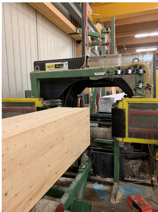
Figure 4.12 Les rouleaux poussent l'élément à travers une machine qui les enveloppe. Après l'emballage, des cornières en carton sont utilisées pour protéger les coins des éléments.
