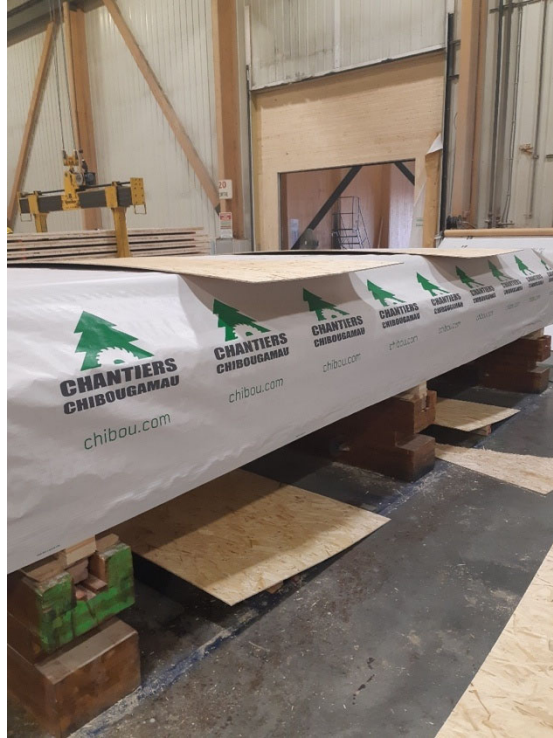
Figure 4.5 Le panneau à copeaux orientés (OSB) est ensuite fixé au fond de l'emballage pour assurer la protection lors de l'utilisation d'un chariot élévateur.
