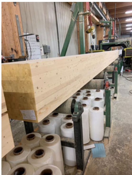
Figure 4.11 Les éléments en bois lamellé-collé sont déposés sur des rouleaux.
