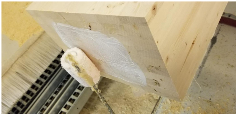
Figure 4.10 Scellant du bois de bout
