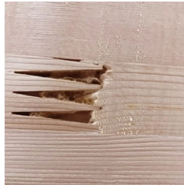
Figure 3.18 Trou dans une enture
