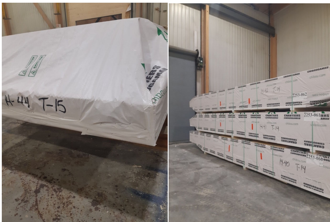
Figure 4.7 Le paquet est ensuite étiqueté conformément aux spécifications et empilé pour l'entreposage.
