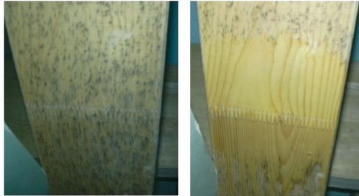
Figure 6.3 Taches de fer (à gauche) et traitement à l'acide oxalique (à droite)
