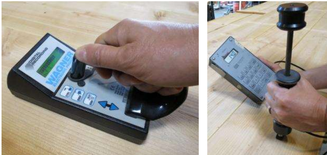
Figure 3.2 Mesure de la teneur en humidité du bois à l'aide d'un appareil basé sur la capacité (à gauche) et d'un appareil basé sur la résistance (à droite) (Source : FPIInnovations)
