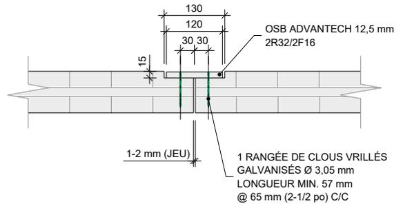
Résistance pondérée au cisaillement : 20 kN/m
