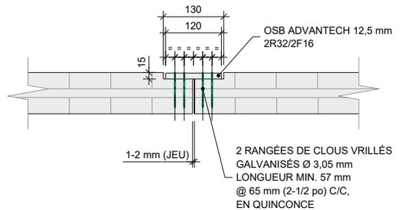
Résistance pondérée au cisaillement : 30 kN/m
