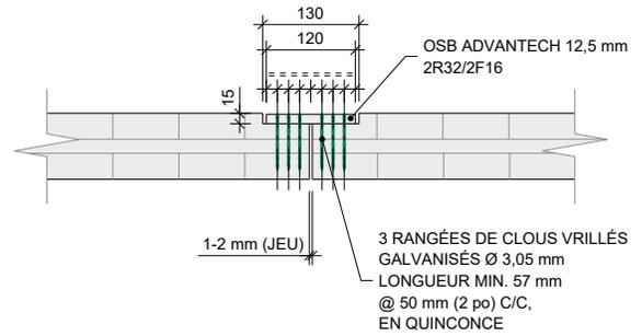
Résistance pondérée au cisaillement : 50 kN/m
