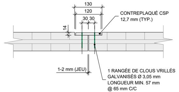
Flux de cisaillement pondéré entre 10 et 20 kN/m
