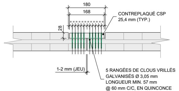
Flux de cisaillement pondéré entre 65 et 80 kN/m
