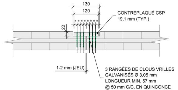
Flux de cisaillement pondéré entre 45 et 65 kN/m
