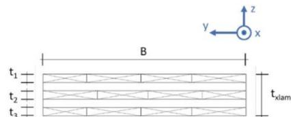
Figure 6.3 – Coupe transversale d'un panneau 5 plis
